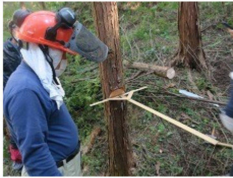
＜左＞追い口切り＜中＞かかり木になりロープで引っ張るも倒れず ＜右＞ロープ位置変え、ウインチ利用により倒す。
