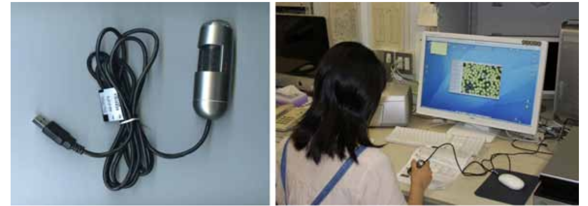
図2. DinoLite Pro 500x（左）、DinoLite Pro 500x の使用の様子（右）
